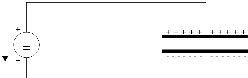
Abb. 9.1.: Spannungsquelle am Plattenkondensator.
